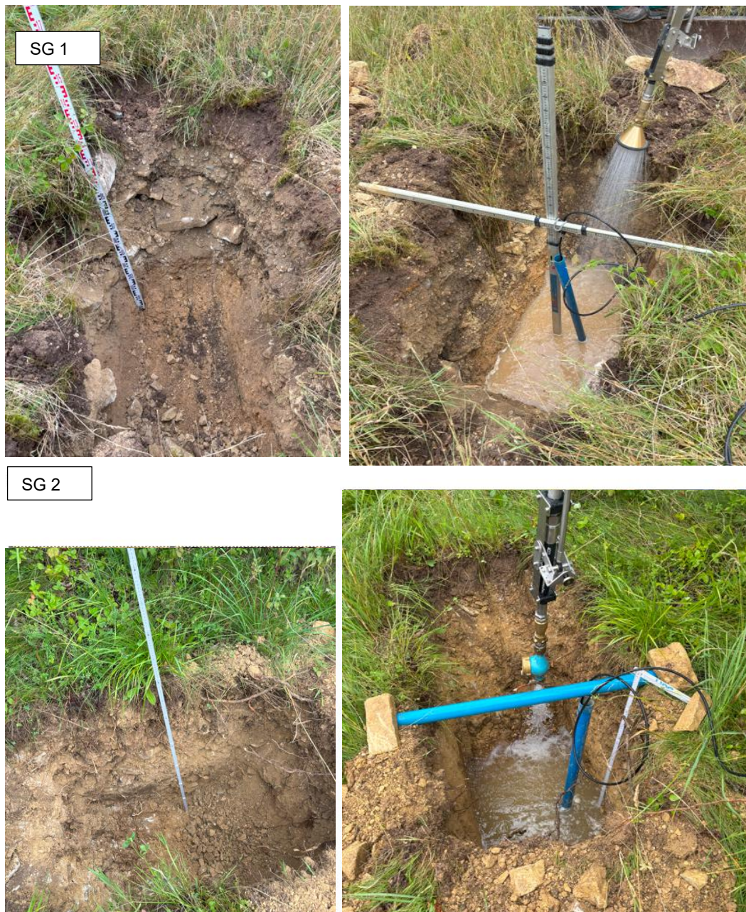
Abb. 2: Schürfgruben SG 1 und SG 2 mit Versickerungsversuch
